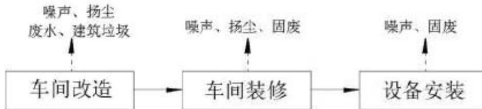
图 2.2-1 项目施工期工艺流程及产污节点图
